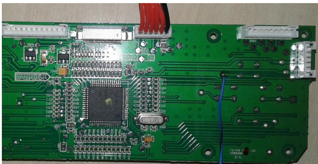
Figura 6 – Ligação do push button UP no rádio.
